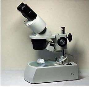
Una risoluzione migliore di una comune lente d'ingrandimento o di una lente contafili (8x - 10x) si ottiene con uno stereomicroscopio.
